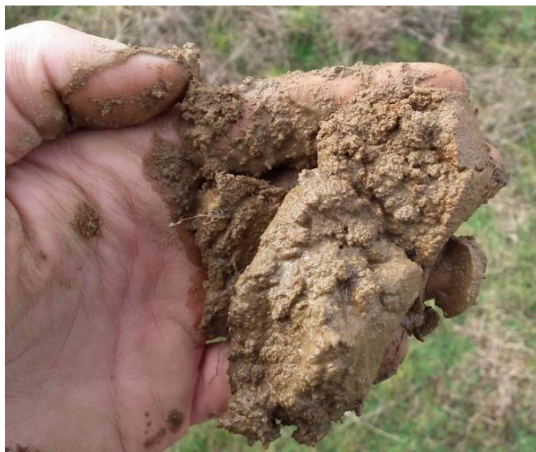
Photo 42 : Traces d'hydromorphie (traces de rouille) apparaissant dans les 25 premiers cm (sondage 33)
