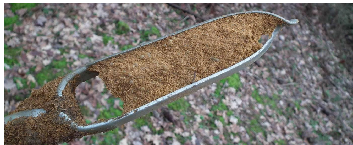
Photo 46 : Sol sableux dans un secteur anciennement remanié (sondage 52)
