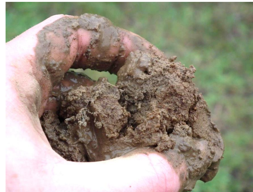
Photo 43 : Traces d'hydromorphie (traces de rouille) apparaissant vers 30 cm (sondage 13)
